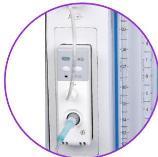
Sistema modular tipo 'plug-in' com identificação automática para adição de parâmetros de Agentes Anestésicos, BIS e Capnografia.
