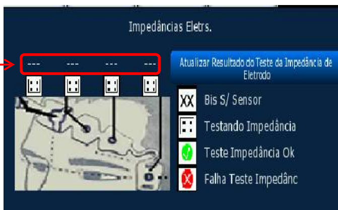
Janela de resultados do teste de impedância do eletrodo
