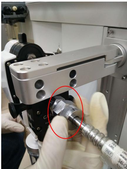
2. Desaperte os quatro parafusos entre o sistema de sucção de vácuo externo e o seu suporte.
