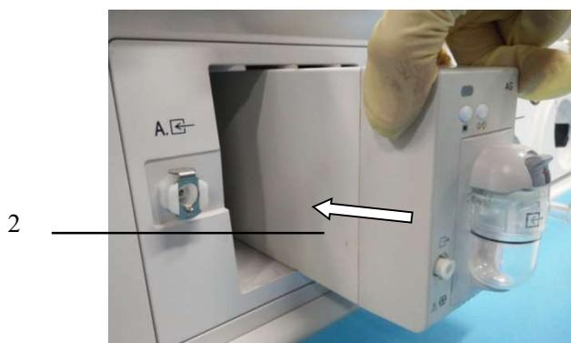
3. Pressione o módulo para a posição até a alavanca na base dar um som “clique”, indicando que o módulo está devidamente fixo. A luz indicadora no módulo acende-se, indicando que o módulo está devidamente instalado.
