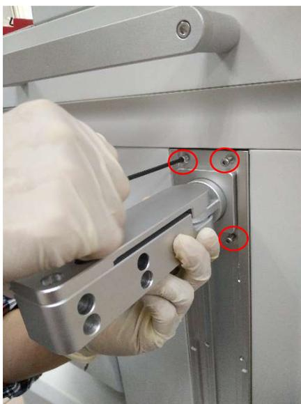
3. Encaixe a sucção de vácuo externo ao apertar os quatro parafusos no suporte.
