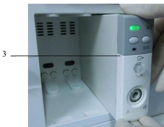
4. Insira uma extremidade do tubo de escape na saída de escape no módulo e rode para a direita, para apertar.
