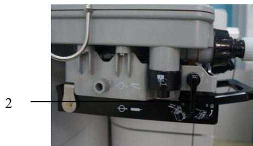
3. Alinhe o depósito de absorvente de CO<sub>2</sub> com a ranhura de montagem do suporte do depósito, conforme ilustrado na imagem direita.
