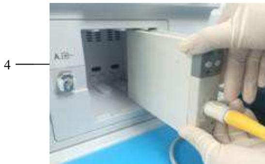
5. A luz indicadora no módulo acende-se, indicando que o módulo está devidamente instalado.
