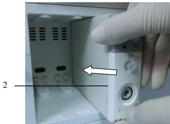
3. A luz indicadora no módulo acende-se, indicando que o módulo está devidamente instalado.
