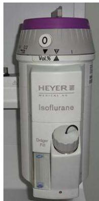
2. Gire a barra de bloqueio para a direita para fixar o vaporizador de anestesia na base do vaporizador, conforme ilustrado abaixo:
