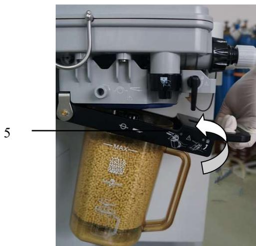
6. O depósito de absorvente de CO<sub>2</sub> foi montado com sucesso, como mostrado na figura a seguir:
