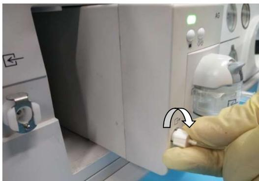
5. Insira a outra extremidade do tubo de escape na entrada de escape da máquina de anestesia. Um som “clique” indica que o tubo está devidamente instalado.
