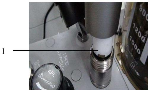
2. Monte o conector da coluna de suporte no conector do sistema de respiração, como mostrado na figura à direita.
