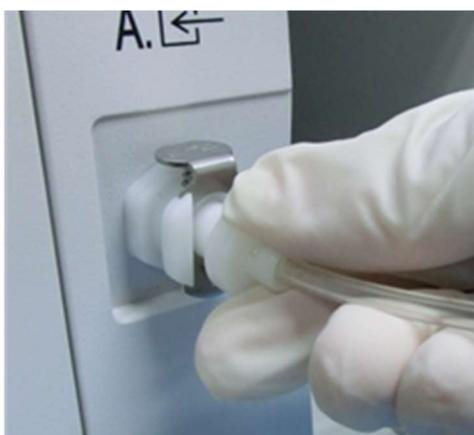
6. Insira uma extremidade do tubo de amostragem na porta do tubo de amostragem e rode para a direita, para apertar.
