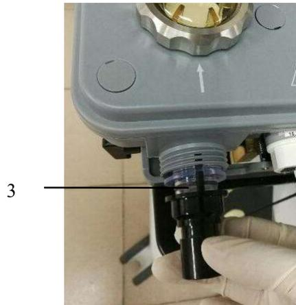
4. Alinhe a junção de respiração e a porca de bloqueio na interface do sensor de fluxo e aperte a porta de bloqueio girando para a direita.
