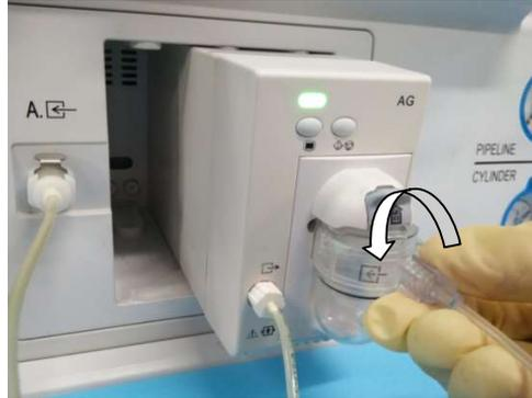
2. Pressione para baixo o clip na saída de exaustão da máquina de anestesia para soltar o tubo de exaustão, e então remova o tubo, como mostrado na figura:
