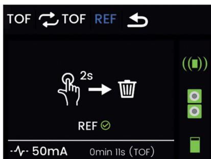
**Nota:** O valor de referência é usado apenas para calcular T4 / Tref durante uma estimulação elétrica TOF e somente se o ToFscan estiver conectado a um cabo com um sensor integrado (sensor acelerômetro).
